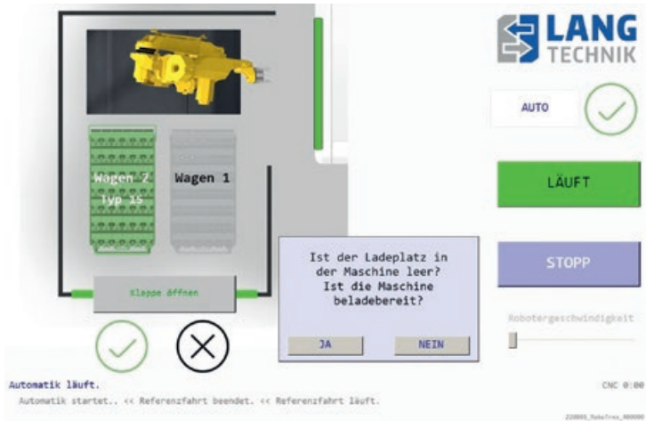
Abbildung 2: Teil im Greifer - Bestätigungsaufforderung
