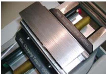
Das Werkstück muss für eine Serienfertigung exakt gespannt und auf dem Schraubstock positioniert werden.
