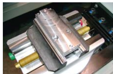
Fast schon fertig: Bearbeitetes Werkstück auf einem Schraubstock von Lang. Bis zu 50 große Paletten finden im Eco-Tower Platz.
